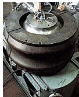
钻石可在3-4周内在这台压缩机中形成(Algordanza)
